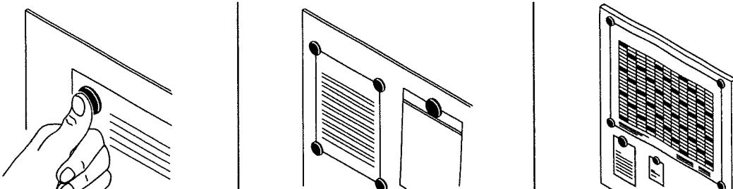
■ Der Laurel Superreissnagel besteht aus einer massiven Kunststoffkappe, die den eingegossenen Reissnagel umschließt. Somit lässt sich der Laurel Superreissnagel garantiert nicht durchdrücken.
